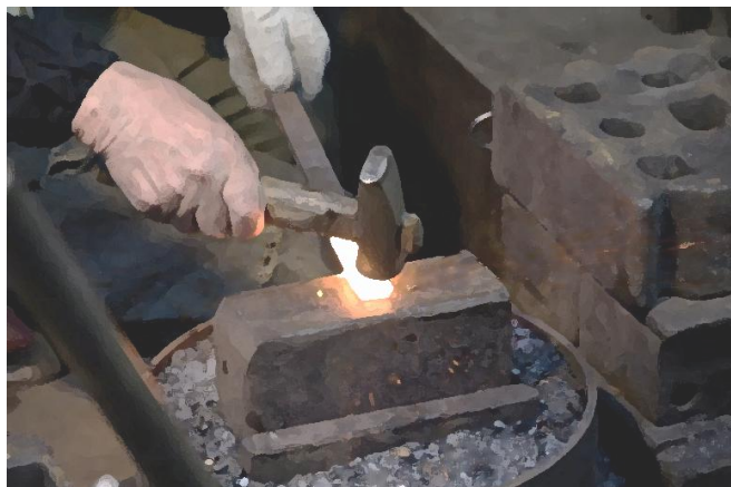
熱した鉄を何度も槌でたたくと、鉄の組織は硬く強くなる (「鍛冶屋の仕事とは」 https://www.rafuju.jp/antiqu-log/ より)
