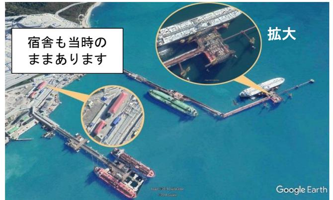
1979年完成。カスピ海のバクーから配管で運ばれた原油を黒海のノボロシースクで外洋に運ぶため、直径28インチの当時最大のローディングアーム（流体荷役装置）を設置しました。（GoogleEarthより、2018年撮影）
